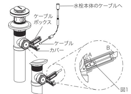
ドレイン本体のカバーを開き、ケーブルの端をケーブルボックスに挿入します。図1に示すように、ケーブルボックスの両端(A、B)にカチッとめ込みます。次に、カバーを固定します。取り付け後、リフティングヘッドを引いて、正常に動作することを確認してください。
